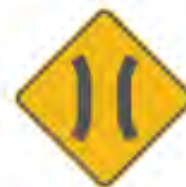
SP-44 PUENTE ANGOSTO
