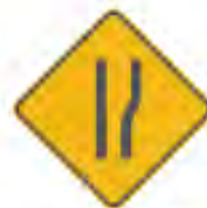
SP-43 ENSANCHE ASIMÉTRICO DE LA CALZADA DERECHA
