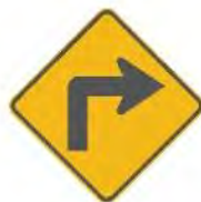
SP-2 CURVA PELIGROSA DERECHA
