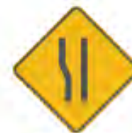
SP-42 ENSANCHE ASIMÉTRICO DE LA CALZADA (IZQUIERDA)
