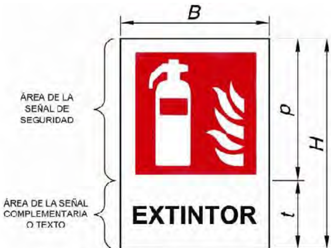
Figura 6b - Dimensiones de la señal en forma de cartel
