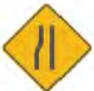
SP-40 REDUCCIÓN ASIMÉTRICA DE LA CALZADA (IZQUIERDA)
