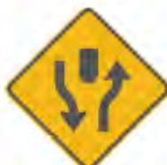
SP-62 INICIO VÍA CON SEPARADOR
