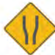
SP-41 ENSANCHE SIMÉTRICO DE LA CALZADA
