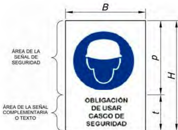
Figura 2b - Dimensiones de la señal en forma de cartel
